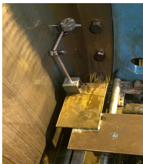
اندازه گیری با دقت ۰,۰۱ میلیمتر
