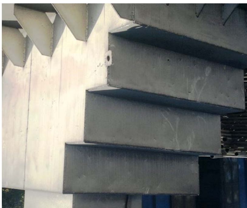
شکل 5: طراحی و ساخت شوت های پله ای برای جلوگیری از سایش دیواره های شوت ، کاهش سرعت و کاهش ضربه مواد و امکان هدایت مواد به مرکز نوار نقاله بعدی ( این شوت ها به شوت های مخزنی نیز معروف هستند )
