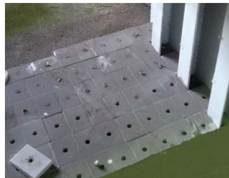
شکل (2) : هر سوراخ ایجاد شده نشانه شکستن یکی از سرامیک ها می باشد
