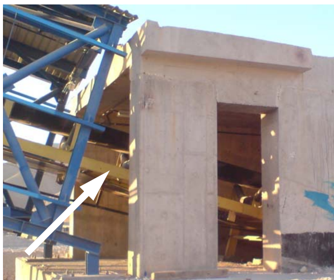
شکل (10) : بلند شدن نوار از روی رولیکها و برخورد با تجهیزات
